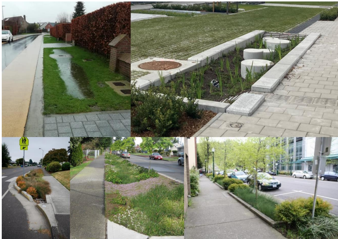
Figuur 17. Vlnr en vbno: (1) Infiltratiekom langs de straat. © Kruisem; (2) Bufferend plantvak (Aziëlaan Wilrijk, tuinstraat). © Aquafin; (4, 5 en 6) Mogelijke vertragsmaatregelen waarbij de inplanting zoveel mogelijk wordt uitgespreid en focust op water vasthouden. © Aquafin.
