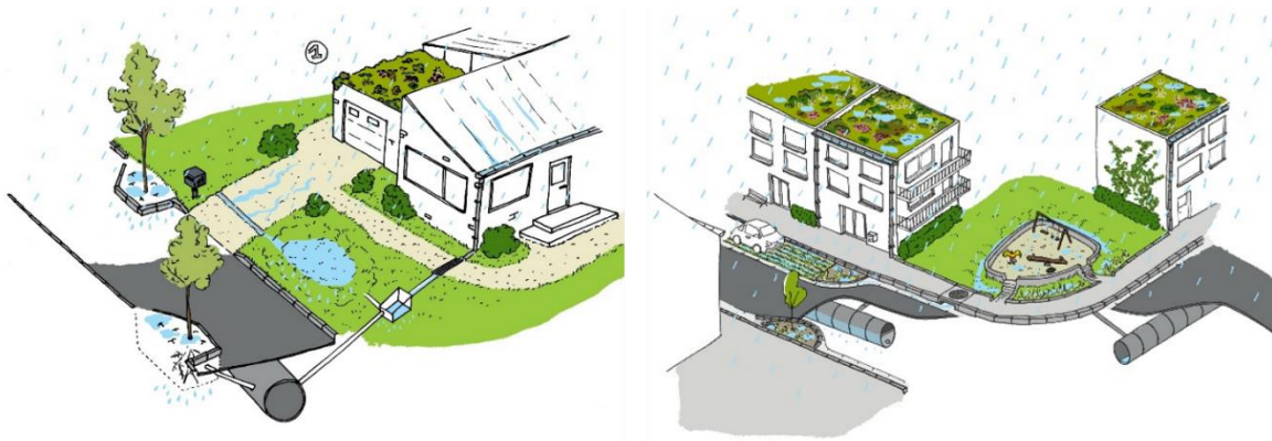
Figuur 7. Opvang en infiltratie van hemelwater bij frequente neerslag © Aquaflin.
