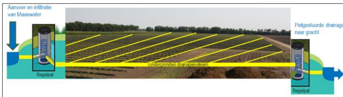
Figuur 34: Principeschets subirrigatie (Boerennatuur, 2023a)
