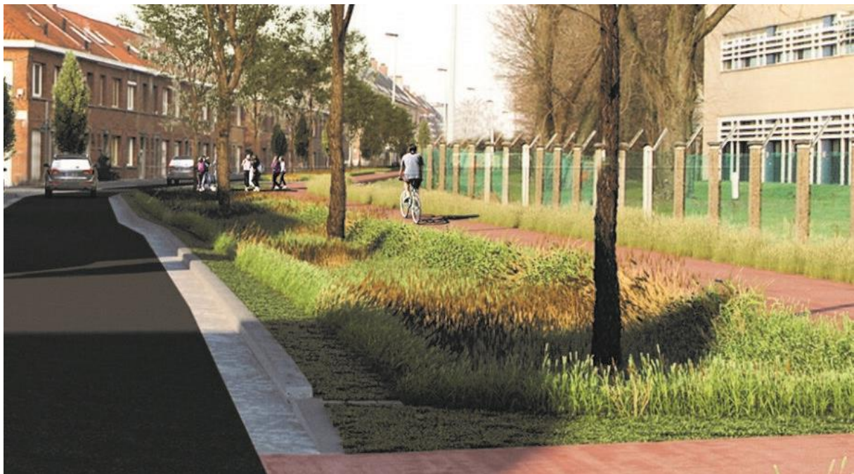
Figuur 22. Voorbeeld van een wadi uit het project Cluster Steenakker Gent. Bron: Blauwgroen Vlaanderen.
