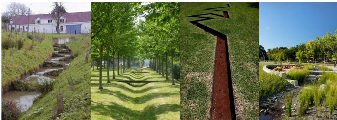
Figuur 26. Blauwgroene afvoerwegen bieden een breed spectrum aan inrichtingsmogelijkheden. Van links naar rechts: een gracht met kunstmatige meandering om te vertragen, een laanvormige infiltratiekanaal, een zeer strak
